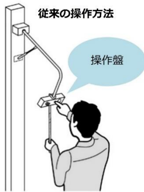
従来の装置は位置を下げるために 紐で引っ張りながら操作
